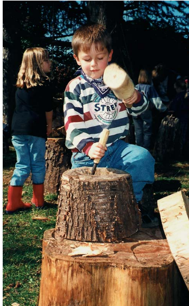
Aus einem Rundholz entsteht mit Hohleisen und Klüpfel ein Vogelnistkasten.
